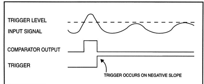
Abbildung: Erzeugung eines Triggersignals - Negative Flanke
