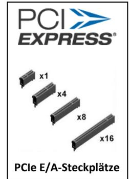
Es ist möglich, den RazorEdge Express in PCIe-Steckplätzen zu betreiben, die mechanisch x8 oder x16 groß sind, aber elektrisch mit langsameren x1- oder x4-PCIe-Geschwindigkeiten arbeiten, obwohl dies die Übertragungsgeschwindigkeit des Digitalisierers reduziert.
