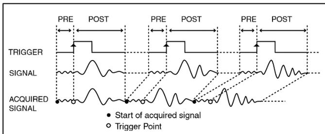
Abbildung: Mehrfachaufzeichnungsmodus mit Pre-Trigger-Daten
