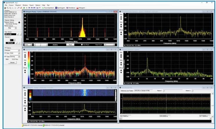
SpectraViewRT ist eine Windows-basierte Anwendung, die es dem Bediener ermöglicht, frühere Signalaufzeichnungen zu öffnen/anzusehen und auf dem Bildschirm zur Analyse wiederzugeben.
