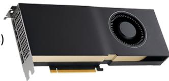
Nutzen Sie hochleistungsfähige GPU-Karten, um die Vorteile der vertrauten C-Programmierungsumgebung mit leistungsstarker parallelisierter Multicore-Vektorverarbeitung für Echtzeit-Signalverarbeitungsroutinen auf den gestreamten Signalen zu nutzen.
