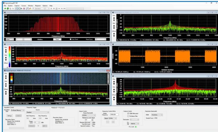
SpectraScopeRT ist eine Windows-basierte Spektrumanalysator-Anwendung, die keine Programmierung erfordert und eine integrierte Betriebssteuerung sowohl des Downconverter-Empfängers als auch des Digitalisierers zur Signalerfassung, -analyse und -aufzeichnung ermöglicht. Es wird jeder Tuner, Downconverter oder Empfänger mit einem IF-Ausgang oder einem virtuellen Empfänger unterstützt.
