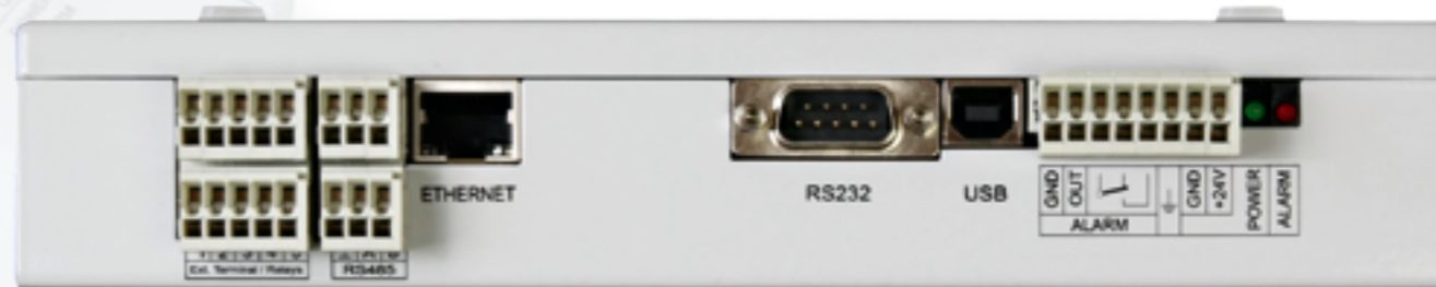
RS232-, RS485- und USB-Ausgänge. Ethernet-Ausgangsschnittstelle ist optional.
