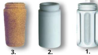
2. F5300 - Sensorabdeckung aus Teflon (PTFE) (weiße Farbe), mit erhöhter Beständigkeit gegen Spritzwasser, nicht saugfähige Oberfläche, rostet nicht. Porengröße 25µm. Temperaturbereich -40°C bis +125°C
